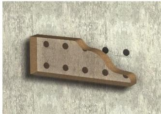
Für leichte Werkstücke kann ein punktweiser Auftrag ebenfalls angewandt werden. In solch einem Fall tritt ein ähnlicher Effekt auf wie bei den senkrechten Strängen.
