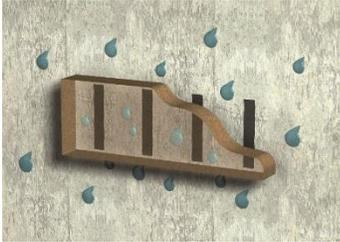
Bei dieser senkrechten Auftragsweise kann sich keine Feuchtigkeit ansammeln, sie tritt unterhalb des Werkstückes wieder aus (Kondensationsfeuchtigkeit oder direkt einwirkendes Wasser).
